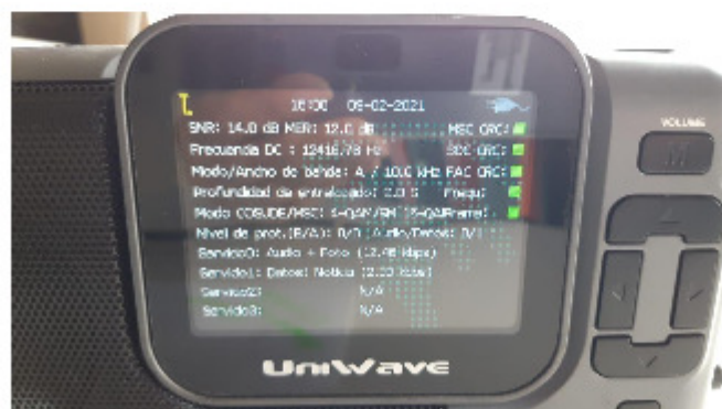
Fig. 15: Fotos da tela de serviço do receptor durante recepção em Roraima - observa-se uma boa SNR 14 [dB] - sinal transmitido a partir de Brasília no modo A DRM.
